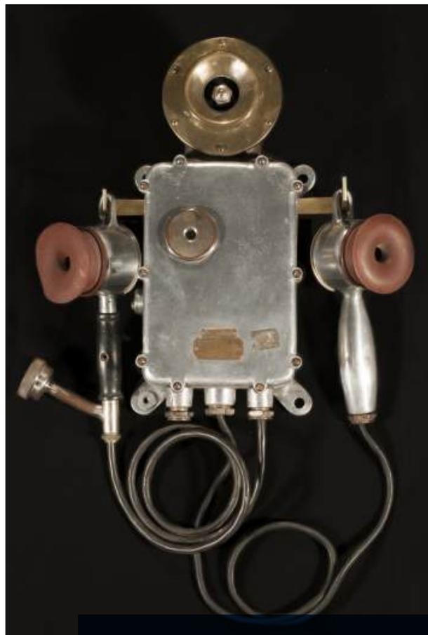
Teléfono de barco (c.1945). Fabricaciones Eléctricas, Navales y Artilleras. Estos teléfonos se caracterizaban por su funcionamiento en condiciones muy adversas; por este motivo se fabricaban con materiales resistentes que soportaban bien la humedad, nunca en hierro o madera.
